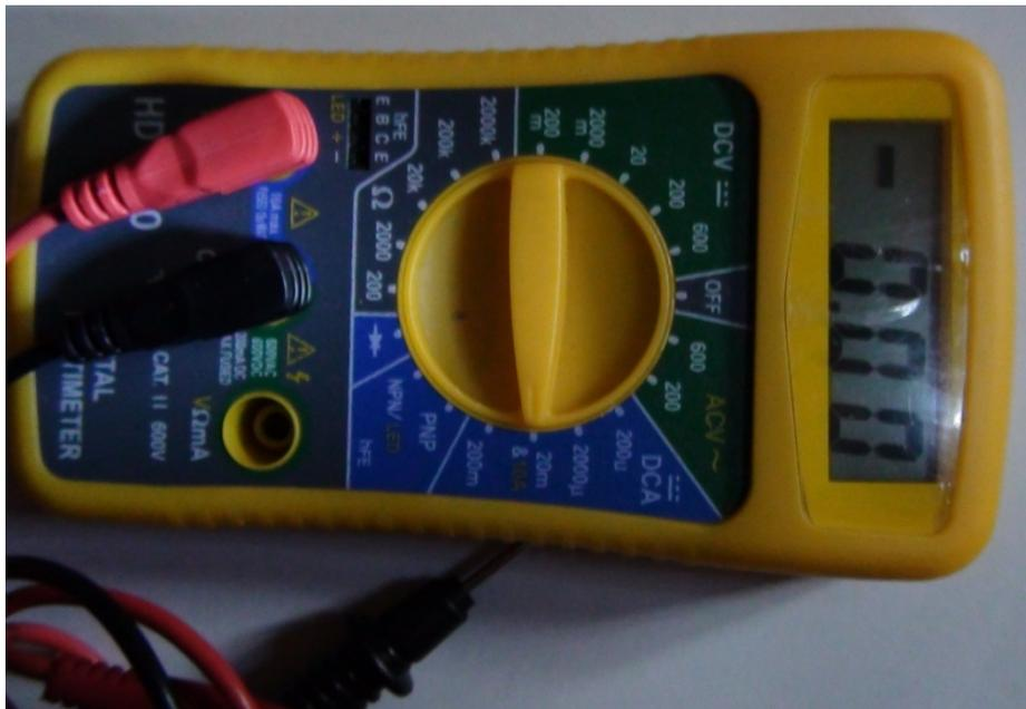
**Abbildung 3:** Digitalmultimeter mit angeschlossenen Prüfkabeln zum Messen von Strömen über 200 mA. Rotes Prüfkabel in „10ADC“ Eingang umstecken und Einstellung „20m&10A“ auswählen.
