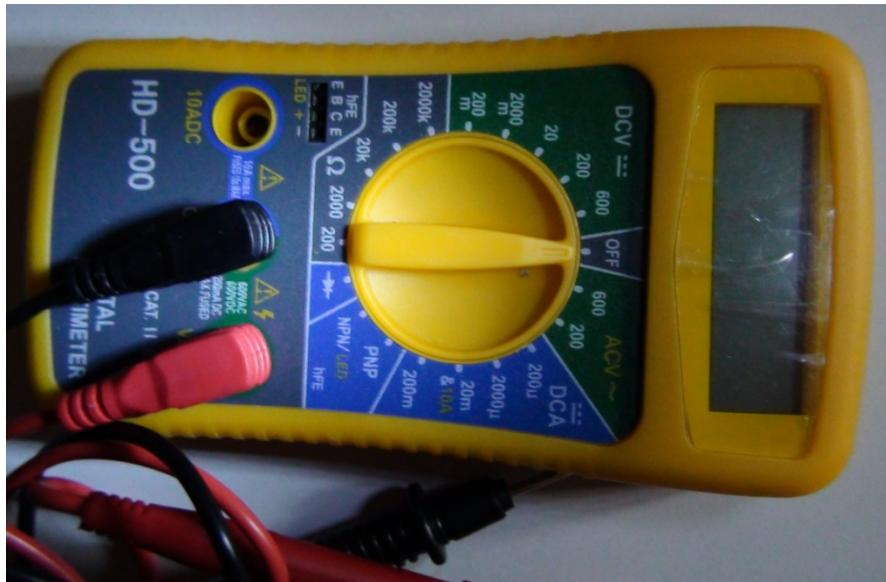
**Abbildung 2:** Digitalmultimeter mit angeschlossenen Prüfkabeln zum Messen von Spannung und Ströme bis 200 mA. Schwarzes Prüfkabel ist negativer Pol und das rote Prüfkabel der positive Pol.
